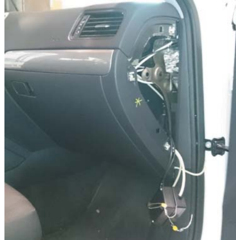
Opción II: a la derecha del salpicadero. En este caso se aprecia también una caja de conexiones del módulo.
