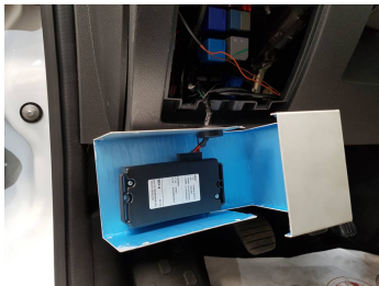
Decodificador de Can Bus instalado
