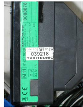
Precinto del fabricante en lateral derecho y USB auxiliar tapado.
