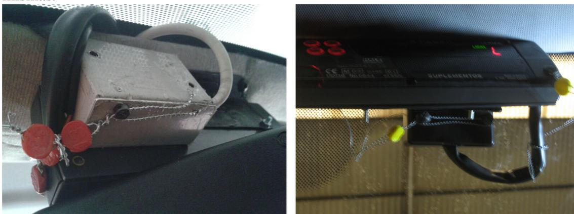
Ejemplos de cajas de conexiones en taxímetro Hale MCT-06
