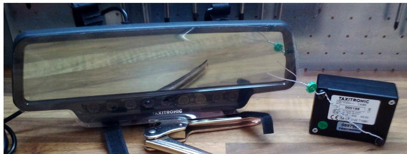
El módulo TX80 dispone de dos tornillos precintables que impiden el acceso a las conexiones. También dispone de un precinto adhesivo del fabricante que impide el acceso a la electrónica.
