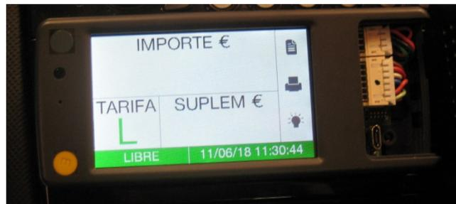
En la parte derecha del taxímetro encontramos otro precinto, que atraviesa un tornillo y una escuadra metálica, que fija una tapa frontal que da acceso a los conectores del taxímetro y al conector USB de cambio de tarifas.
