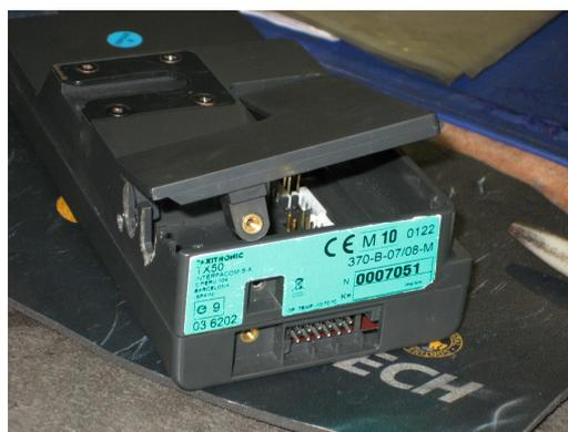
Tapa de conexiones, y conector de cambio de tarifas
