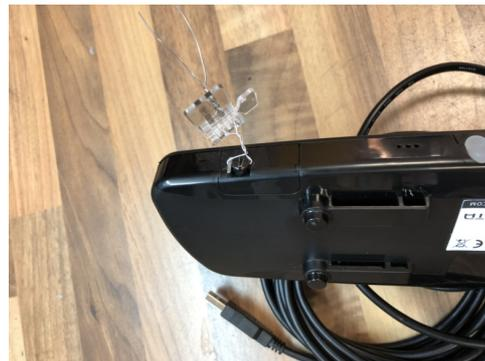
Las conexión entre el ATA Box y el Air S ha de ser continua y sin empalmes. El módulo ATA Box se instalará de forma que, aunque esté oculto a la vista, sea fácilmente accesible para comprobar el precintado.
