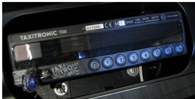
Precinto adhesivo del fabricante y precintado de dos tornillos en TX40
