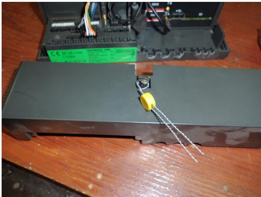
Tapa de conexiones retirada en la que se aprecia el tornillo de sujeción precintado de manera simulada
