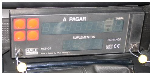
Modelo 05 con precinto del instalador sustituyendo al del fabricante
