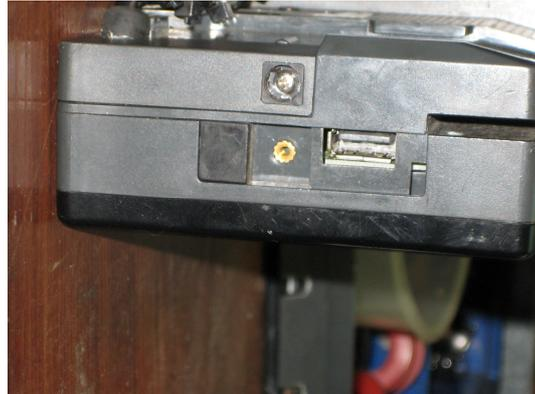
Tapa de conexiones en su sitio. Se observa tornillo de sujeción y conector USB para cambio de tarifas
