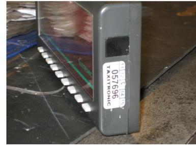
Precinto adhesivo del fabricante en lateral derecho.
